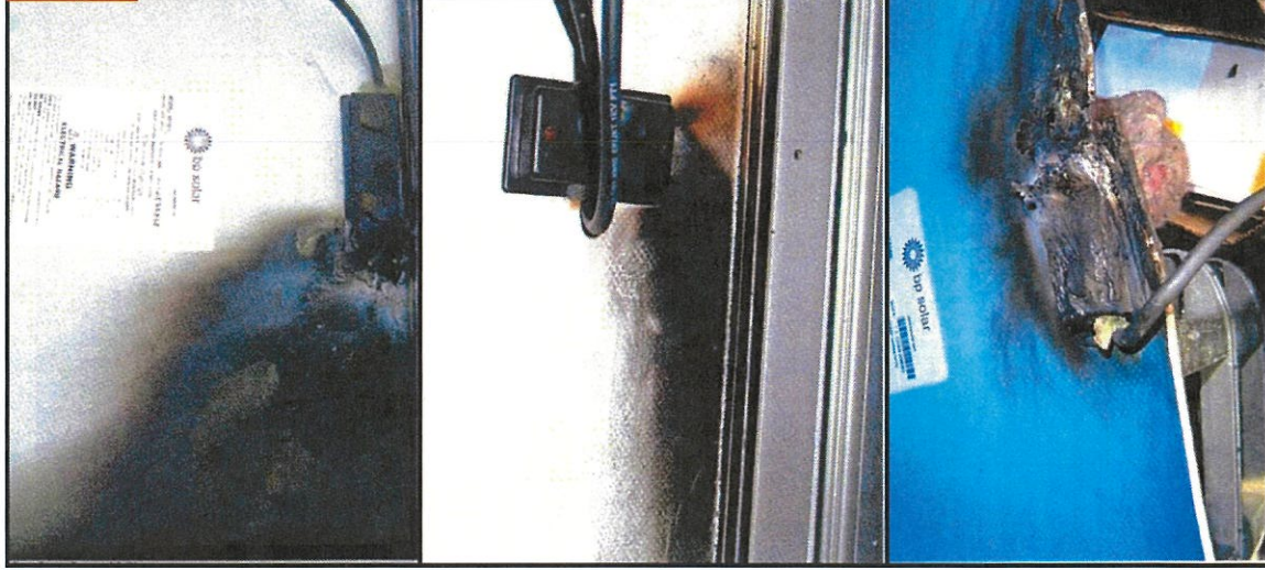
Quelques exemples des effets des arcs électriques sur les installations PV
